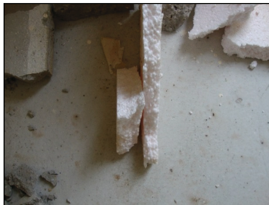
Abb. 7+8: Bei direktem Kontakt zwischen ausgelaufenem Heizöl und der Polystyrol-Dämmschicht, kann diese fast vollständig aufgelöst werden.
