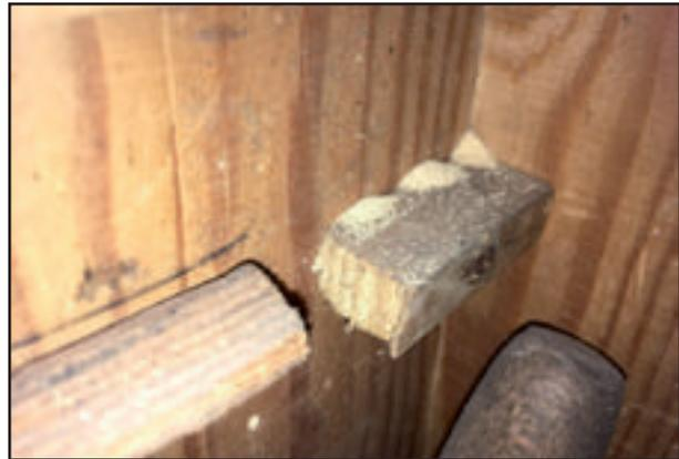
Abb. 2: Fraßmehl nach Anobienbefall im Mobiliar bei einer Holzfeuchte von 14 %.
