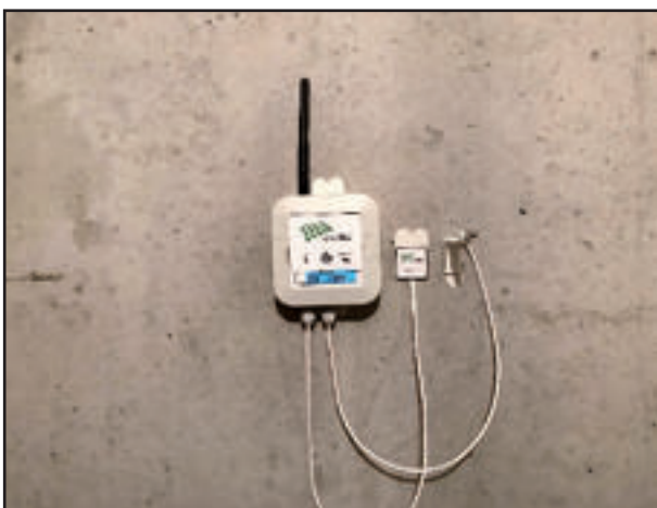
Knotentyp 2: Oberflächentemperatur- und Umgebungstemperaturmessung
