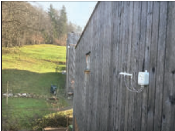
Knotentyp 2: Oberflächen- und Umgebungstemperaturmessung
