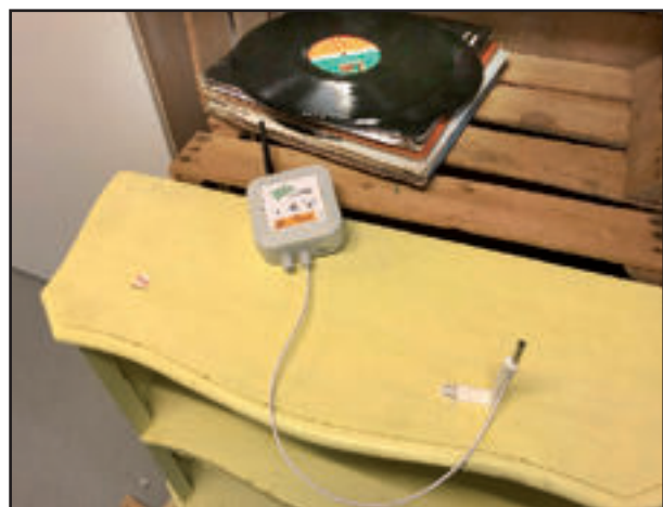
Knotentyp 3: Umgebungstemperatur- und Raumfeuchtemessung
