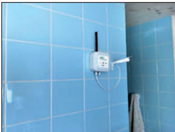
Knotentyp 3: Umgebungstemperatur- und Raumfeuchtemessung
