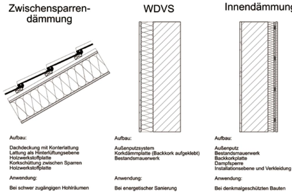
Abb. 3: a) Kork als Schüttung im Dach b) Kork als WDVS c) Kork als Innendämmung
