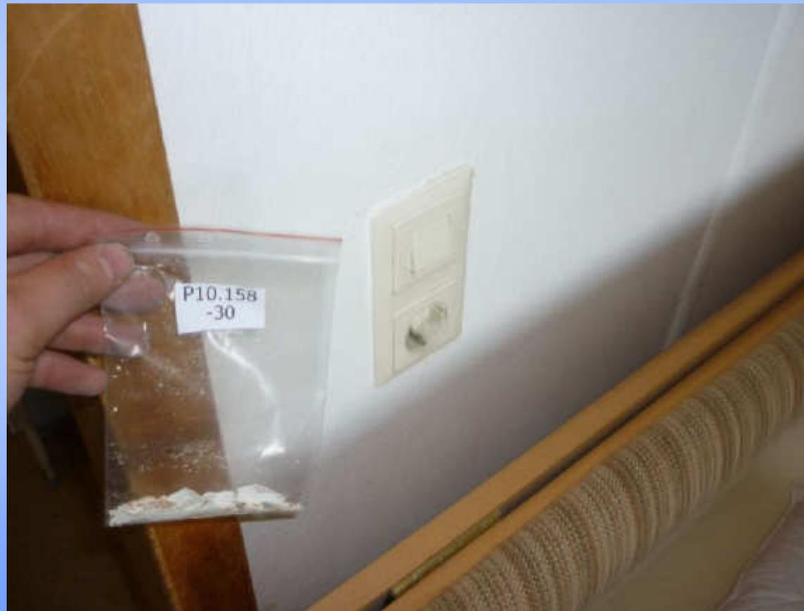
Fugenfüller und Spachtelungen auf Gipskartonwänden
