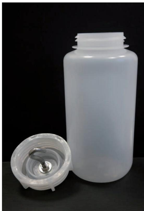
Abb. 1: Polyethylenflasche mit Deckel und integriertem Haken für die Probenaufhängung.
