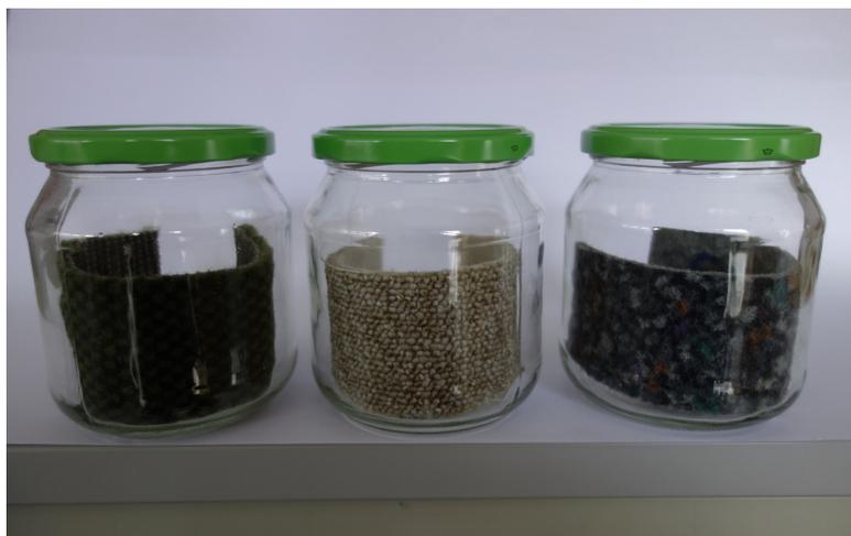
Abb. 1: Schraubgläser dienen als einfaches Mittel der Vorprüfung von Material mit evtl. Geruchsbelastung zu untersuchen (Quelle: W. Steinhäuser)
