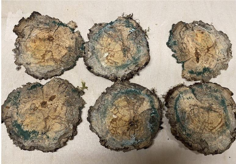
Abb. 8: Beim Aufschneiden des Holzes sind die Fraßgänge sehr gut sichtbar (Quelle: Justus von Diepenbroick)
