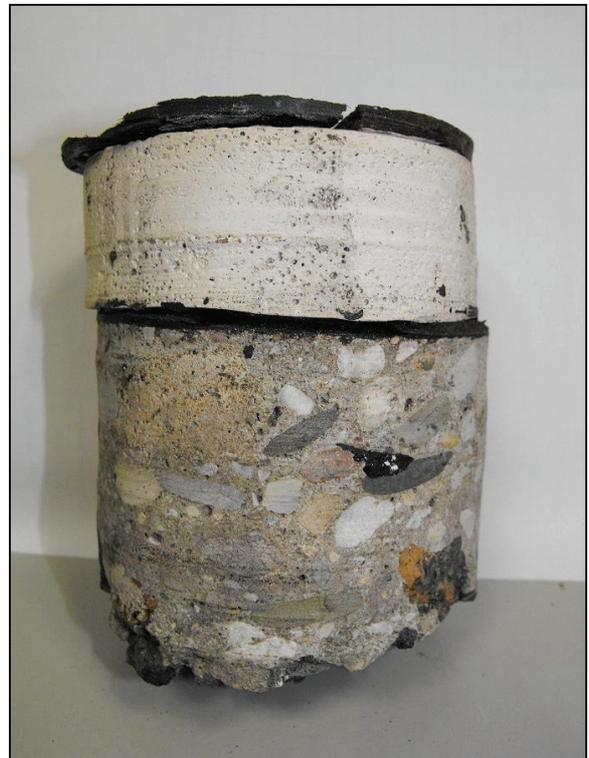
Abb. 2: Bohrkern mit PAK - belasteter Trennlage
